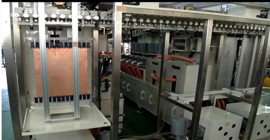
ABF電路板處理完成自動下料系統
