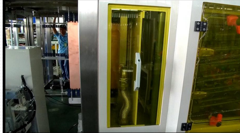
ABF 電路板進行第2次藥液處理
