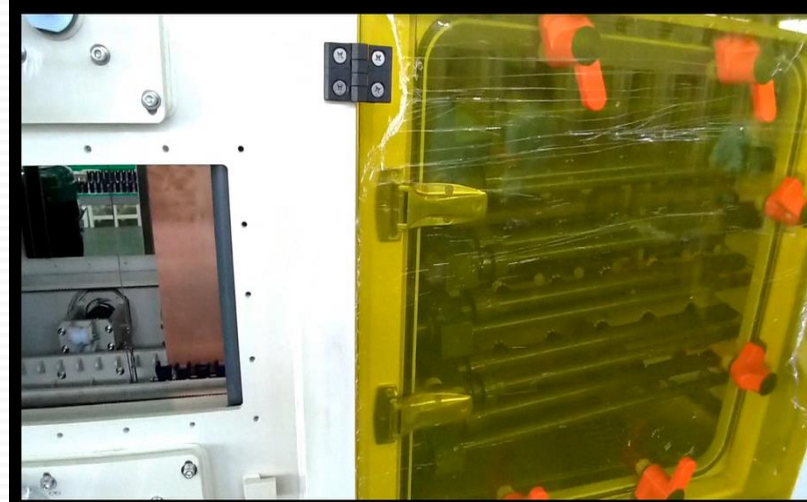
ABF 電路板進行第2次藥液處理
